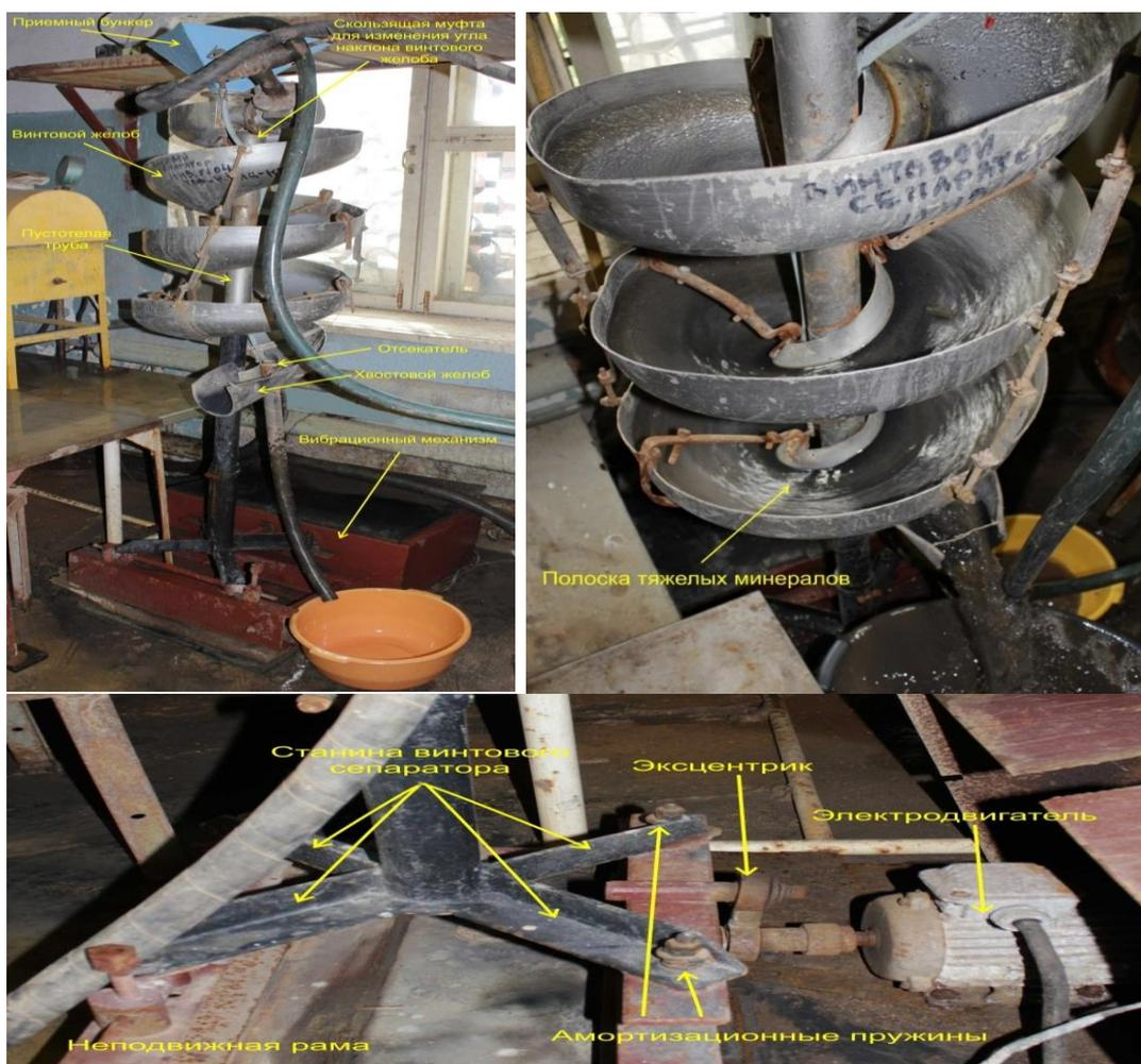
Рисунок 10 – Вибровинтовой сепаратор
