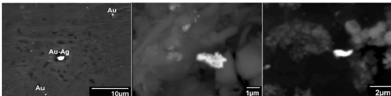
Рисунок 3 - Частицы самородного золота из конденсатов паро-дымовой смеси на 1, 2 и 3 стадиях осаждения
